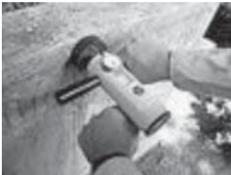
Hierbei werden die Grabsteine mit Hilfe des Kipp-Testers mit einem Druck von 300 N geprüft.
